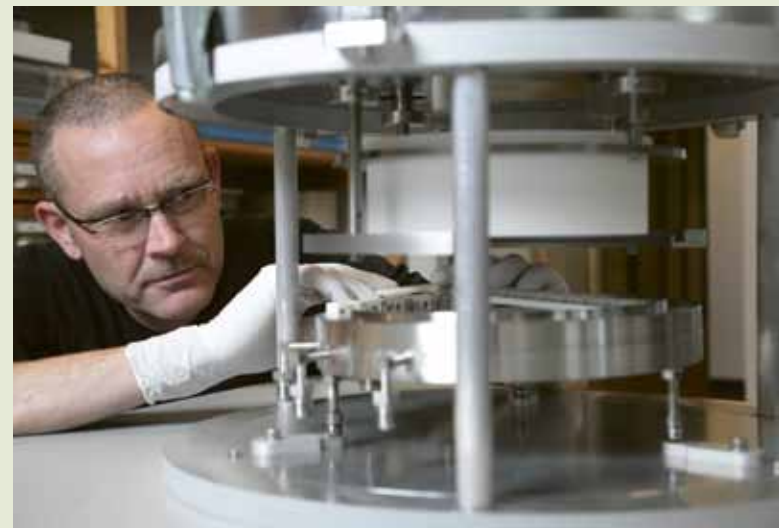
Assemblage van een nieuwe reactor voor processen op extreem hoge temperaturen, als uitbreiding op het cluster-systeem in het Nanolab.
