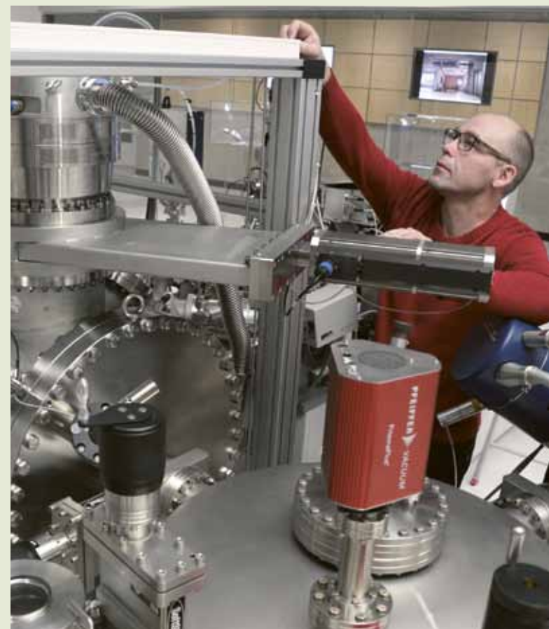
Het samenbouwen van een nieuw depositiesysteem als deel van een grote ultrahoogvacuüm onderzoeksofstelling.
