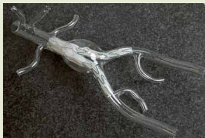
Deze glazen aorta wordt gebruikt voor het oefenen met inbrengen van stents, door studenten technische geneeskunde.
