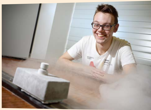
De proef 'Zweeftrein' is spectaculair vanwege de stikstofdampen die nodig zijn om de magneten te koelen. Kinderen leren iets over magnetisme en supergeleiding.
