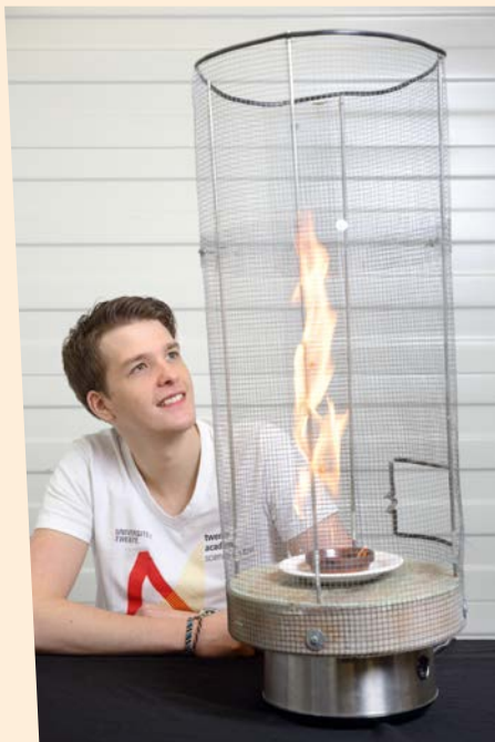
Deze vuurkolk laat het effect zien van een verticale luchtstroom, ontstaan door de opstelling rond te draaien, op een kleine vlam.
